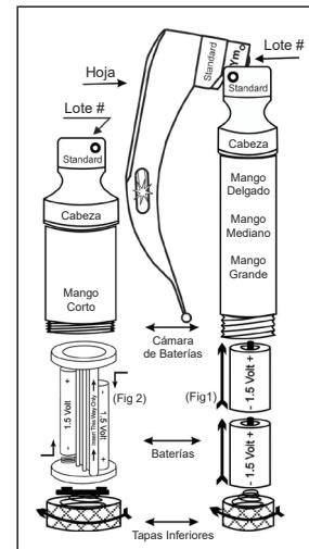
**Cambio de Lámpara:** Antes de remover la lámpara, permita que se enfrie. Para reemplazar la lámpara, desenrosquela y retírela de la hoja. Reinstale una lámpara nueva en la hoja y apriétela. Asegúrese que la lámpara esté colocada correctamente y verifique que encienda antes de usar.
